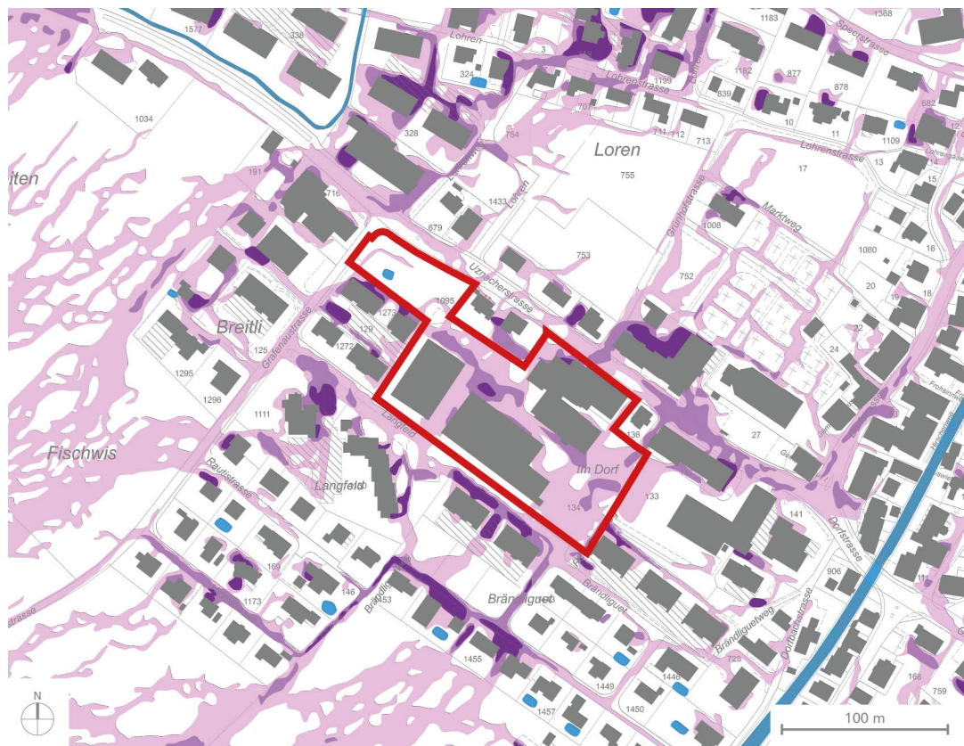
Abb. 29: Plananschnitt Gefahrenkarte Oberflächenabfluss (Quelle: Geoportal SG, Planungsgebiet rot umrandet), rosa = Fliesstiefe h \leq 0.1\text{m} / pink = Fliesstiefe h \leq 0.25\text{m} / violett = Fliesstiefe h > 0.25\text{m}
