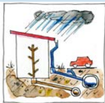
Schematische Darstellung eines Trennsystems
