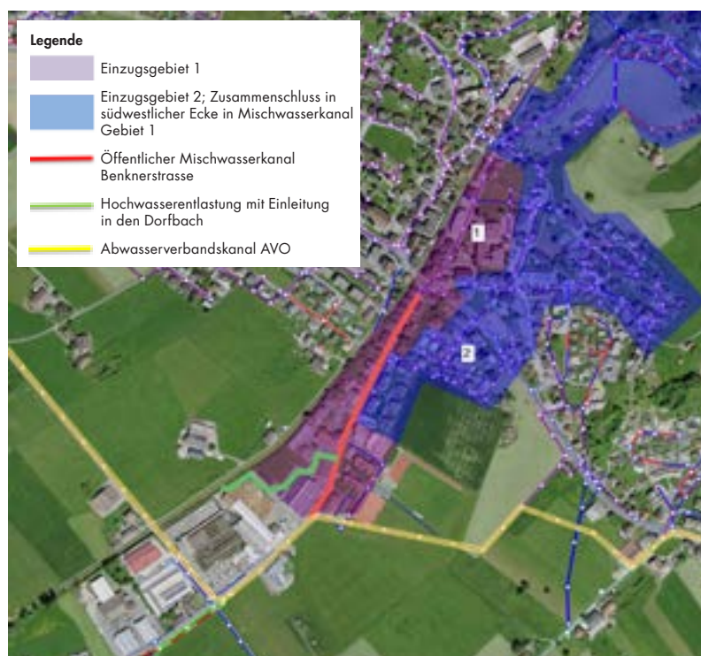
Übersicht bestehendes Abwassersystem
