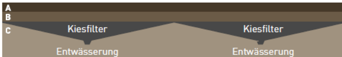
Abbildung 3: Einbau von Entwässerung bei Oberflächenneigungen < 4 % gemäss FSKB Rekultivierungsrichtlinie.
